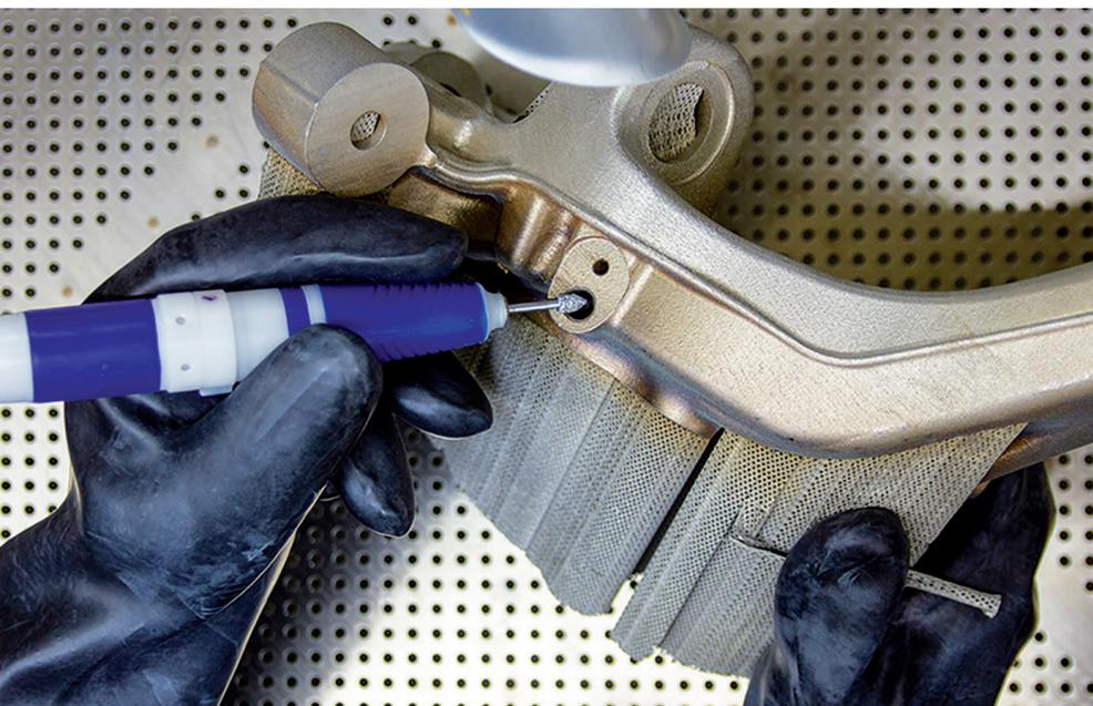
**Entpulvern, entgraten, schleifen:** In der Eneska Postpro können verschiedenste Nacharbeiten durchgeführt werden. (© Joke)
